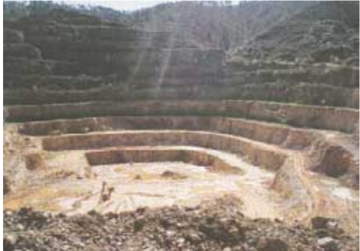
Cantera de caliza y dolomía en el Naranco, Oviedo, donde se ven, junto a la profundización de la explotación, los bancales rehabilitados (Arcelor-Mittal, 2009)
